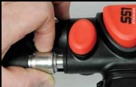
FIG. 8: CONEXIÓN DE LA DESCONEXIÓN RÁPIDA
