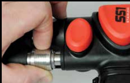
FIG. 8: FASTGØRELSE AF LYNKOBLING
