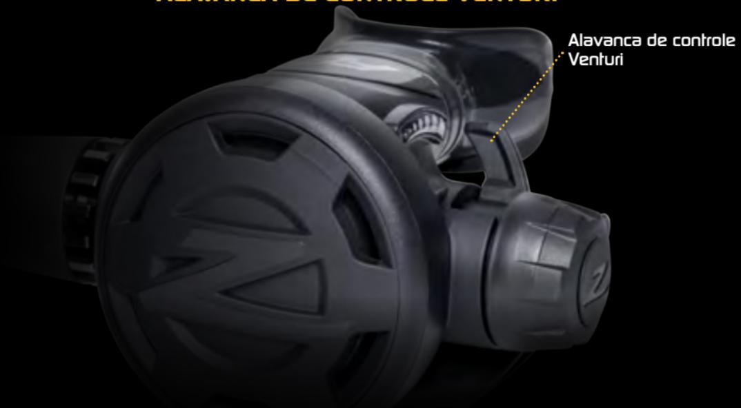
Essa alavanca controla a sensibilidade do regulador. As posições DIVE (mergulho) e PRE-DIVE (pré-mergulho) estão marcadas ao lado da alavanca. Para evitar fluxos livres inesperados do venturi na superfície ou ao entrar na água, a alavanca deve ser colocada na posição PRE-DIVE (**para frente**). Assim que o mergulhador estiver pronto para descer, a alavanca deve ser colocada na posição DIVE (**para trás**).
