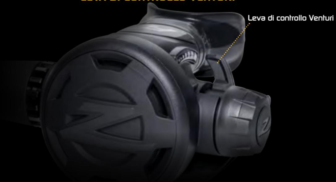
Questa leva controlla la sensibilità dell'erogatore. Le posizioni DIVE e PRE-DIVE della leva sono indicate sulla cassa, accanto alla leva stessa. Per evitare flussi continui dovuti all'effetto Venturi in superficie, o durante l'entrata in acqua, la leva dovrebbe essere in posizione PRE-DIVE (**cavanti**). Non appena il subacqueo è pronto a scendere, la leva dovrebbe essere spostata sulla posizione DIVE (**indietro**) .
