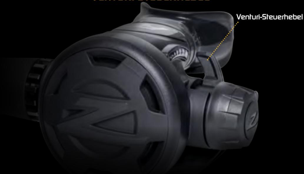
Mit diesem Hebel wird die Empfindlichkeit des Atemreglers eingestellt. Die DIVE- und PRE-DIVE-Positionen für den Hebel sind auf dem Gehäuse neben dem Hebel markiert. Um unerwartete Venturi-Freisetzung an der Oberfläche oder beim Eintauchen ins Wasser zu vermeiden, sollte der Hebel in die Position PRE-DIVE (**vorwärts**) gestellt werden. Sobald der Taucher zum Abtauchen bereit ist, sollte der Hebel in die Position DIVE (**zurück**) gebracht werden.
