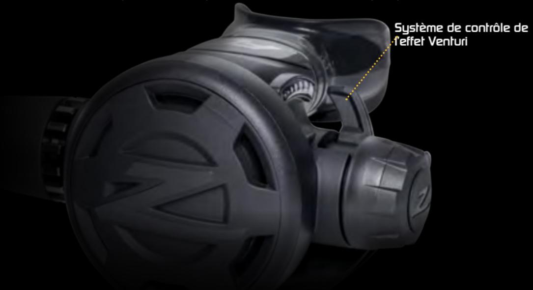
Ce système permet de contrôler la sensibilité du détendeur. Les positions PLONGÉE et PRÉ-PLONGÉE du levier sont indiquées sur le boîtier à côté du levier. Pour éviter la mise en débit continu imprévue du levier Venturi à la surface ou à l'entrée dans l'eau, il doit être placé en position PRÉ-PLONGÉE (**avant**). Dès que le plongeur est prêt à descendre, levier doit être placé en position PLONGÉE (**arrière**).
