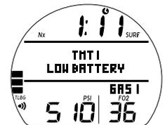
Fig. 5B - BATERÍA BAJA DEL TMT (Alarma)
