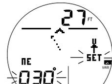
Fig. 119 - AJUSTE RUMBO DE REFERENCIA (rotar hasta el rumbo deseado)
