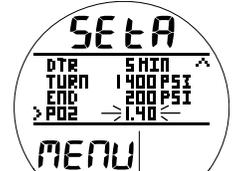
Fig. 24B - AJUSTE PO<sub>2</sub> (cambiando el ajuste)
