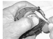
Fig. 138 - AJUSTE DEL ANILLO DE LA CUBIERTA
