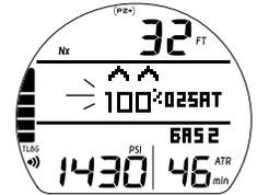
Fig. 68 - ALARMA DE O<sub>2</sub> (en Deco, hasta salir a superficie)
