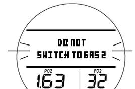
Fig. 75 - ALARMA DE CAMBIO DE GAS
