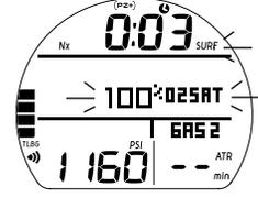
Fig. 69 - PRINCIPAL ALARMA DE O<sub>2</sub> ALTO (en superficie < 10 min)
