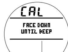
Fig. 121A - ACCEDER A CALIBRACIÓN (dar vuelta la unidad boca abajo)
