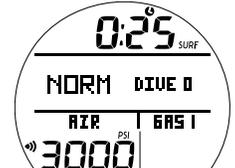
Fig. 6A - PRINCIPAL MODO NORM EN SUPERFICIE (ninguna inmersión realizada, fijado para Aire)
