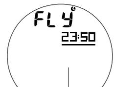
Fig. 84 - VOLO (10 min. dopo l'immersione)
