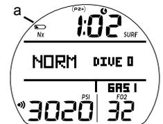
Fig. 3 - AVVERTENZA BATTERIA SCARICA
