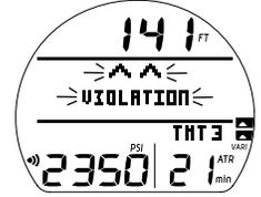
Fig. 61 - VIOLAZIONE MODALITÀ GAUGE PRINCIPALE (dopo l'allarme acustico)
