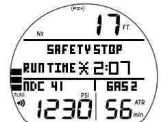
Fig. 50B - PRINCIPALE SOSTA DI SICUREZZA (impostata per contatore di esercizio precedente l'immersione)
