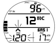
Fig. 63 - AVVISO PO<sub>2</sub> (durante l'attivazione dell'allarme acustico)
