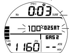
Fig. 69 - ALLARME O<sub>2</sub> ALTO (in superficie < 10 min.)
