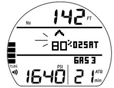
Fig. 66 - AVVISO O<sub>2</sub> (durante l'attivazione dell'allarme acustico in curva)
