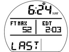
Fig. 94 - FREE SURF ALT 1 (ultima immersione)
