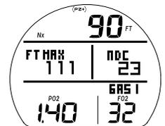
Fig. 11B - PDPS (Gas 1 impostato su Nitrox)
