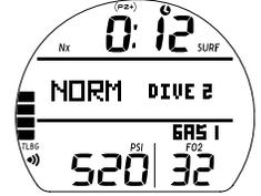
Fig. 6B - NORM SURF PRINCIPALE (dopo immersione n. 2 Nitrox)
