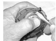
Fig. 138 - SERRAGGIO DELL'ANELLO DEL COPERCHIO
