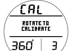
Fig. 122 - PER AVVIARE LA TARATURA
