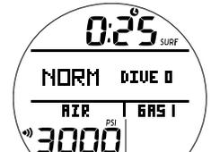
Fig. 6A - NORM SURF PRINCIPALE (nessuna immersione ancora effettuata, impostato su Air)
