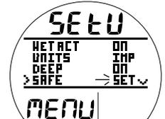
Fig. 26B - IMPOSTAZIONE SOSTA DI SICUREZZA (per accedere a Impostazione profondità/tempo)
