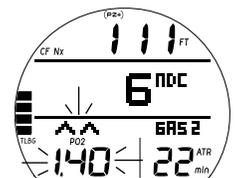
Fig. 64 - ALLARME PO<sub>2</sub> (durante l'attivazione dell'allarme acustico)
