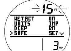
Fig. 26C - IMPOSTAZIONE SOSTA DI SICUREZZA (profondità/tempo)
