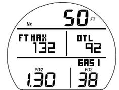
Fig. 11C - PDPS (O<sub>2</sub> valore di riferimento per i tempi)
