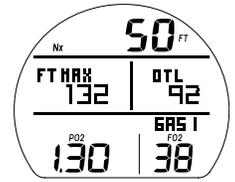
Abb. 11C - PDPS (durch O<sub>2</sub> kontrollierte Zeiten)
