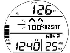
Abb. 67 - O<sub>2</sub> ALARM (Nullzeit, bis zur Oberfläche)
