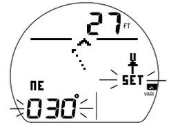
Abb. 119 - EINST. REF-ZIELRICHTUNG (in die Zielrichtung drehen)
