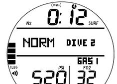
Abb. 6B - NORM SURF HAUPT (nach Nitrox-Tauchgang 2)
