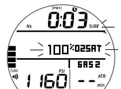
Abb. 69 - O<sub>2</sub> HOCH ALARM (auf Oberfläche < 10 Min.)
