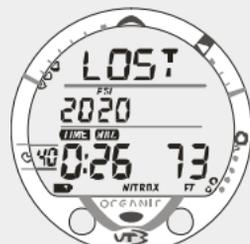
Fig. 61 – collegamento subacqueo interrotto
