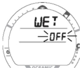
Fig. 36 - Réglage de l'activation par immersion.
