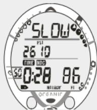
L'alarme sonore retentit, la DEL rouge clignote et le message SLOW > SLOW défile en clignotant en haut de l'écran (Fig. 67). L'alarme sonore et la DEL s'arrêtent en appuyant sur le bouton A pour en accuser réception ou si la vitesse baisse. Le message continue de défiler en clignotant jusqu'à ce que la vitesse baisse.
