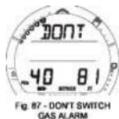
Fig. 87 - Alarme "Ne pas changer de gaz".
