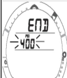
Fig. 33 - Réglage de l'alarme de la pression de réserve
