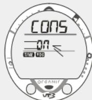
**Fig. 39 - Réglage de la marge de sécurité**
