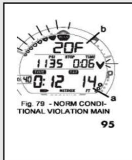
**NOTE :** dès l'entrée dans l'un des 3 modes Infraction différée ci-dessous, la DEL rouge clignote et l'alarme sonore retentit même si elle est réglée sur OFF. Elle ne peut pas être coupée en appuyant sur le bouton A pour en accuser réception.
