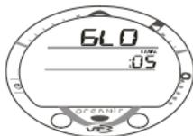
Fig.40- Réglage de la durée d'éclairage
