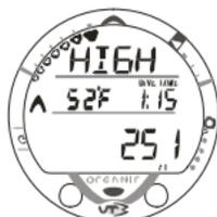
Fig. 121 - Affichage principal plongée FREE (pendant alarme azote).
