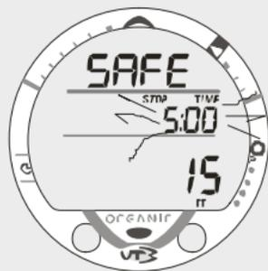
fig. 38- - Réglage du palier de sécurité
