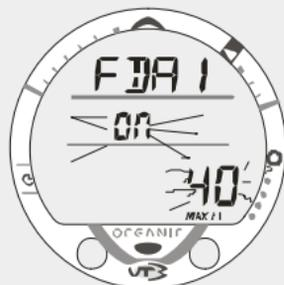
Fig. 111 - Réglage de la 1<sup>ère</sup> alarme de profondeur FREE.
