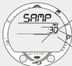
Fig. 41 - Réglage de la fréquence d'échantillonnage.
