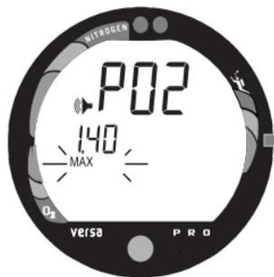
Abb. 34 - Einstellung maximales PO2 Signal
