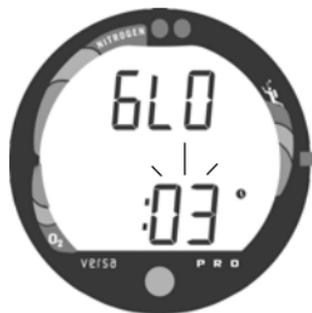
Abb. 36 - Einstellen der Dauer der Hintergrundbeleuchtung
