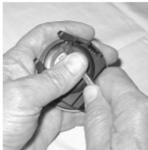
Abb. 91 - Entfernen des Abdeckringes
