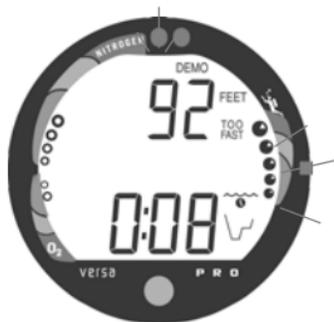
Abb. 86 - Beschleunigte Aufstiegs geschwindigkeit
