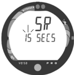
Abb. 37 - Einstellung des Messintervalls in Sekunden
