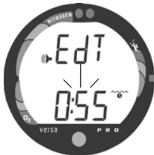
Abb. 22 - Einstellung Alarm bei abgelaufener Tauchzeit
