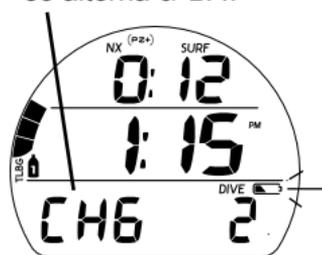
Fig. 2 - CAMBIAR BATERÍA
