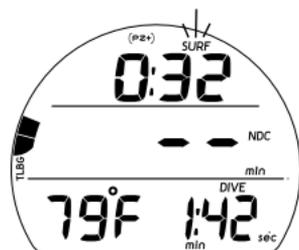
Fig. 102 - PRINCIPAL INMERSIÓN EN MODO FREE (durante < 1 min en superficie)
