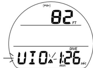
Fig. 109 - VIOLACIÓN EN MODO FREE (APNEA) (luego de la alarma sonora se alterna c/ min:seg)
