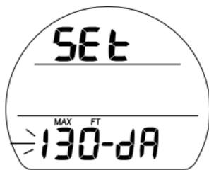
Fig. 21 - AJUSTE ALARMA PROFUNDIDAD
