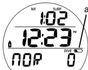
Fig. 1 - BATERÍA BAJA
