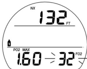
Fig. 16B - AJUSTE FO2 PARA GAS 1
