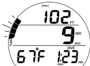
Fig. 108 - ALARMA DEL TLBG EN MODO FREE (durante la alarma sonora)
