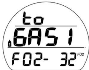
Fig. 78 - VISTA PREVIA DEL CAMBIO DE GAS 1
