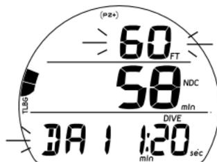
Fig. 107 - ALARMA DE PROFUNDIDAD
