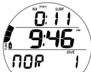
Fig. 3B - PRINCIPAL MODO NORM EN SUPERFICIE (> 10 min después de la inmersión n° 1)
