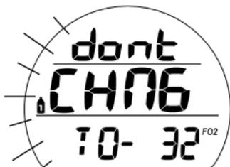
Fig. 80 - ALARMA DE CAMBIO DE GAS (todo parpadeando)
