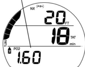
Fig. 74 - ALARMA PO2 (durante la descompresión)
