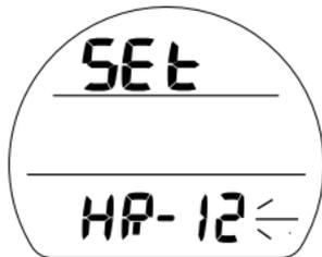
Fig. 37 - AJUSTE FORMATO HORARIO
