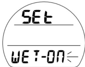
Fig. 27 - AJUSTE ACTIVACIÓN POR CONTACTO HÚMEDO
