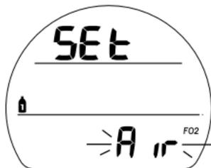
Fig. 16A - AJUSTE FO2 PARA GAS 1
