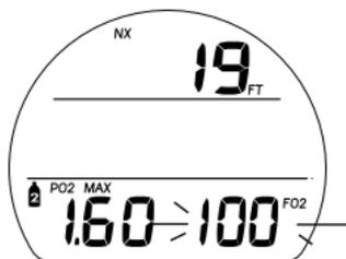
Fig. 17 - AJUSTE FO2 PARA GAS 2
