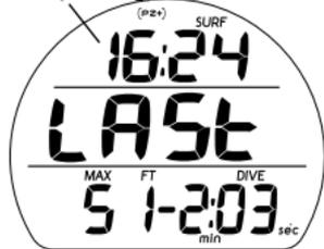
Fig. 91 - PANTALLA ALTERNATIVA 1 DEL MODO FREE EN SUPERFICIE (datos de la última inmersión)
