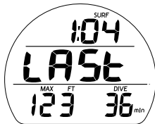
Fig. 4 - NORM SURF ALT 1 (dati relativi all'ultima immersione)
