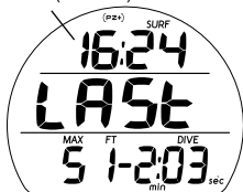
Fig. 91 - FREE SURF ALT 1 (dati relativi all'ultima immersione)
