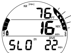
Fig. 49 - IMMERSIONE PRINCIPALE (velocità di risalita eccessiva)
