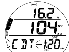
Fig. 105 - ALLARME CONTO ALLA ROVESCIA
