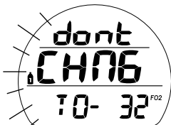
Fig. 80 - ALLARME COMMUTAZIONE GAS (tutti i valori lampeggianti)
