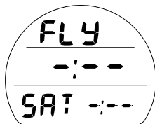
Fig. 7A - FLY/SAT (nessuna immersione dall'attivazione)
