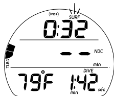
Fig. 102 - IMMERSIONE FREE PRINCIPALE (periodo < 1 min. in superficie)
