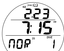
Fig. 11B - ANTEPRIMA LOG (dopo immersione 1 NORM)
