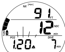
Fig. 72 - AVVERTENZA PO2 (durante l'attivazione dell'allarme acustico)
