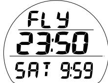
Fig. 7B - FLY/SAT (10 min. dopo l'immersione)
