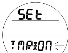
Fig. 30B - IMPOSTAZIONE CRONOMETRO SOSTA DI SICUREZZA
