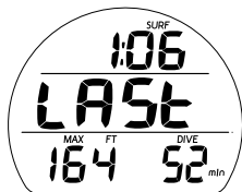
Fig. 82 - GAUG SURF ALT 1 (dati relativi all'ultima immersione)
