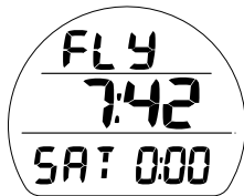
Fig. 7C - FLY/SAT (nessun tempo di desaturazione residuo)
