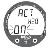
Fig. 39 – Ajuste de Activación por Agua.
