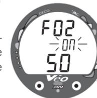
Fig. 35 – Ajuste del Valor Predeterminado del 50% de FO2
