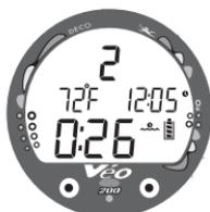
Fig. 67 - Modo de Superficie (&gt;10 min.)
