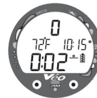
Fig. 16A- Modo Superficie (El módulo está seco)
