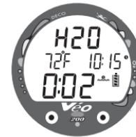
Fig. 16B- Modo Superficie (El módulo está mojado)
