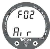
Fig. 10 - FO2 configurado para Aire
