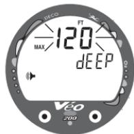
Fig. 21 - Ajuste de la Alarma de Profundidad Máxima
