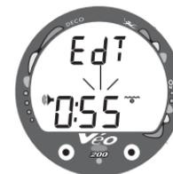
Fig. 22 - Ajuste de la Alarma de Tiempo de Inmersión Transcurrido.
