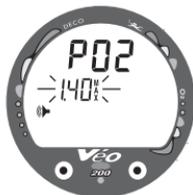
Fig. 34 – Ajuste de la Alarma de máximo PO2
