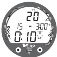
Fig. 49 - Parada de Seguridad en No Deco
