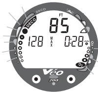
Fig. 59 - Violazione immediata Modalità di misurazione (sott'acqua)
