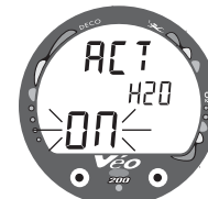
Fig. 39 – Impostazione dell'attivazione in acqua
