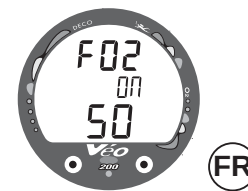
Fig. 12 - FO2 par défaut sur "ON".
