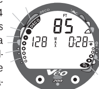
Fig. 59 - Violation immédiate mode Profondimètre (en plongée).
