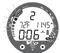
Fig. 60 - Violation immédiate mode Profondimètre (en surface).
