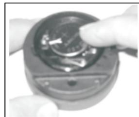
Fig. 92 - Einlegen der Batterie
