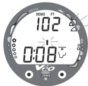
Fig. 86 - Simulierter Aufstieg
