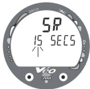
Fig. 37 - Einstellung Abtast Rate
