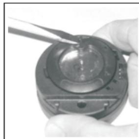
Fig. 90 - Entfernen des Rings
