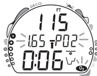
Fig. 52 - Alarma de PO2
