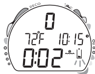
Fig. 9 - Condición de Batería Baja
