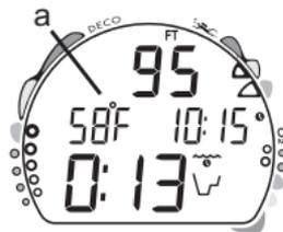
Fig. 7 - Display della temperatura
