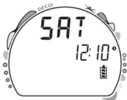
Fig. 60 - tempo di desaturazione
