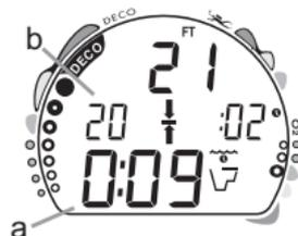
Fig. 40 - sosta di decompressione
