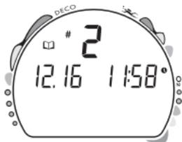
Fig. 62 - Log (identificativo dell'immersione)
