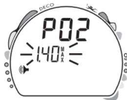
Fig. 26 - Impostazione dell'allarme di PO2
