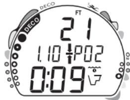
Fig. 44 - sosta decompressiva schermo alternativo #3
