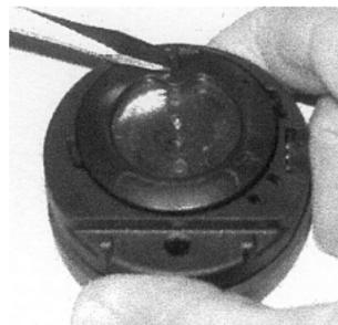
Fig. 71 - Rimozione dell'anello
