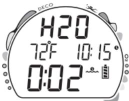
Fig. 66B - modalità di superficie (contatti bagnati)
