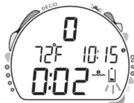
Fig. 9 - Situazione con un livello basso della batteria
