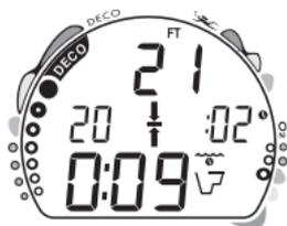
Fig. 41 - schermo stop decompressivo
