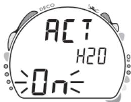
Fig. 29 - Réglage de l'activation par immersion.
