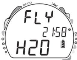
Fig. 67 - Temps de désaturation
