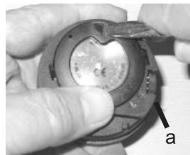
Fig. 70 - FIXIERUNG DES HAL-TERINGS
