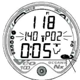
Fig. 48 - HOHER PO2 ALARM
