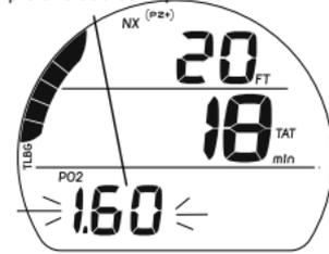
Fig. 58 - ALARMA PO2 (en la parada de descompresión)
