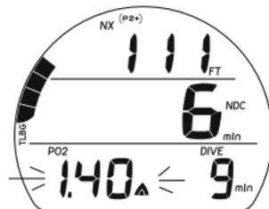
Fig. 57 - ALARMA PO2 (hasta < valor de ajuste)
