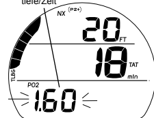
Abb. 58 - PO2 ALARM (bei Dekostopp)
