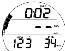
Abb. 14 - TAUCH HAUPT (während < 10 Minuten an der Oberfläche)
