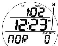
Abb. 7 - WARNUNG SCHWACHE BATTERIE
