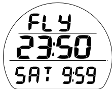
Abb. 22A - FLY/DSAT-ZEIT (Std:Min Zeiten angezeigt)
