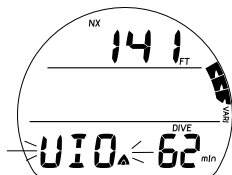
Abb. 54 - VGM AKTIVIERT (während der ersten 10 Sekunden)
