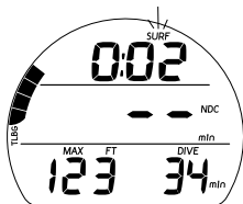
Abb. 39 - NULLZEIT HAUPT (an der Oberfläche < 10 Minuten)
