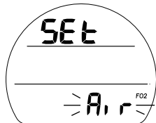
Abb. 25A - EINSTELLEN FO2 (Einstellung Luft)
