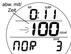
Fig. 61 - SURF MAIN (>10 Min. nach Tauchgang)
