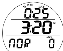
Fig. 13 - OBERFLÄCHE HAUPT (noch keinen Tauchgang durchgeführt)
