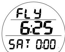
Abb. 22B - FLY/SAT-ZEIT (keine Dsat-Zeit verbleibend)
