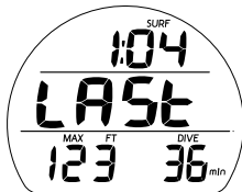
Abb. 15 - OBERFLÄCHE ALT 1 (Datum letzter Tauchgang)
