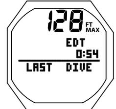
Fig. 26 - NORM SURF ALT 1 (dati relativi all'ultima immersione)
