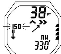
Fig. 152 - INVERSIONE ROTTA DI RIF. (invertire da 330° a 150°)
