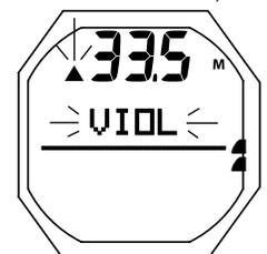
Fig. 89 - VIOLAZIONE MODALITÀ GAUGE PRINCIPALE (dopo l'allarme acustico)
