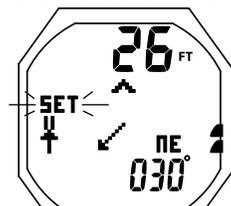
Fig. 151 - IMPOSTAZIONE ROTTA DI RIFERIMENTO (ruotare fino a raggiungere la rotta desiderata)
