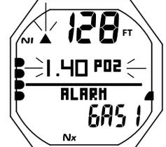
Fig. 93B - ALLARME PO<sub>2</sub> PRINCIPALE
