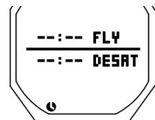
Fig. 30 - FLY/DESAT (< 10 min. dopo l'immersione)
