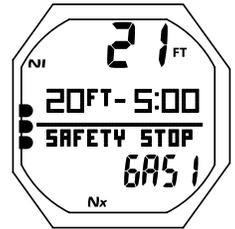
Fig. 74 - SOSTA DI SICUREZZA PRINCIPALE (profondità/tempo di sosta impostati)
