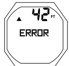
Fig. 65 - ERRORE (durante l'immersione)
