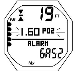
Fig. 96 - ALLARME PO<sub>2</sub> ALTA (100%) (in modalità Decompressione)
