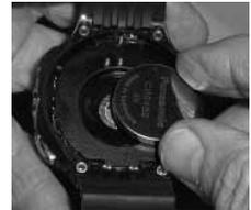
Fig. 169 - INSTALLAZIONE DELLA BATTERIA
