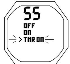
Fig. 48A - IMPOSTAZIONE SOSTA DI SICUREZZA (CONTO ALLA ROVESCIA)
