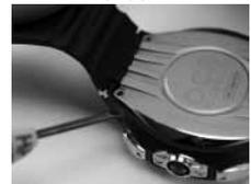
Fig. 166A - PER ALLENARE IL COPERCHIO DELLA BATTERIA
