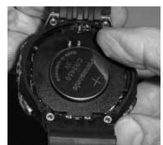
Fig. 167 - RIMOZIONE DELLA BATTERIA
