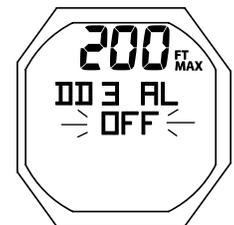
Fig. 133A - IMPOSTAZIONE ALLARME DD3
