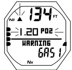
Fig. 93A - AVVISO PO<sub>2</sub> (durante l'attivazione dell'allarme acustico)
