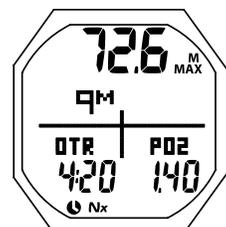
Fig. 32B - PDPS (controllo ossigeno)
