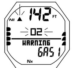
Fig. 97 - AVVISO O<sub>2</sub>ALTO (80%) (durante l'attivazione dell'allarme acustico)
