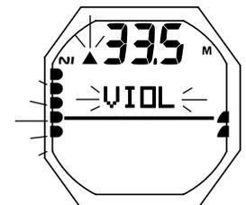
Fig. 88 - VIOLAZIONE MODALITÀ GAUGE PRINCIPALE (durante l'attivazione dell'allarme acustico)
