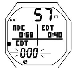
Fig. 138 - ALL. CONTO ALLA ROVESCIA IN IMMERSIONE
