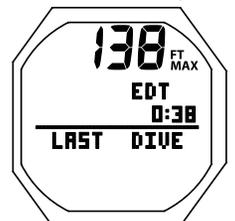
Fig. 125 - FREE SURF ALT 1 (dati relativi all'ultima immersione)
