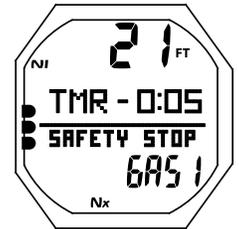
Fig. 75 - SOSTA DI SICUREZZA PRINCIPALE (impostata per uso cronometro)
