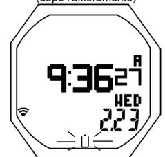
Fig. 4 - MODALITÀ OROLOGIO (allarme batteria scarica)
