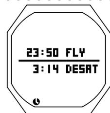
Fig. 29 - FLY/DESAT (10 min. dopo l'immersione)
