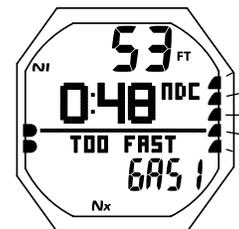
Fig. 62 - IMMERSIONE PRINCIPALE (velocità di risalita eccessiva)
