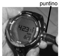
Fig. 162 - CAVO DI INTERFACCIA PC (inserirlo posizionando il puntino a ore 12)
