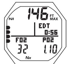
Fig. 106 - PANTALLA ALT. 1 ALARMA DE PO<sub>2</sub>
