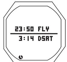
Fig. 30A - PROHIBICIÓN DE VUELO/SATURACIÓN (10 minutos luego de la inmersión)
