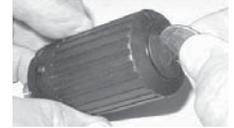
Fig. 170 - RETIRAR BATERÍA
