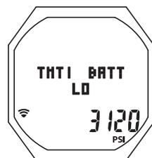
Fig. 6 - ESTADO DE LA BATERÍA DEL TMT
