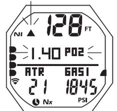
Fig. 101 - PRINCIPAL ALARMA DE PO<sub>2</sub>
