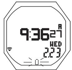
Fig. 5 - MODO RELOJ (Alarma de batería baja)
