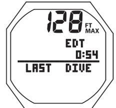
Fig. 27 - ALT 1 MODO NORM EN SUPERFICIE (Datos de la última inmersión)
