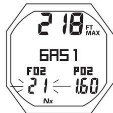
Fig. 36B - AJUSTE FO<sub>2</sub> PARA GAS 1
