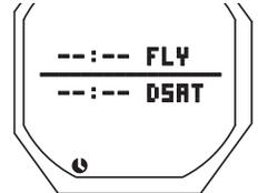
Fig. 30B - PROHIBICIÓN DE VUELO/SATURACIÓN (< 10 minutos luego de la inmersión)
