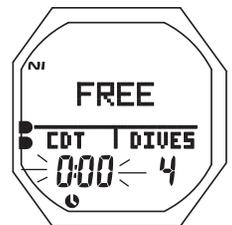
Fig. 129 - PRINCIPAL EN SUPERFICIE (durante la alarma del CDT)
