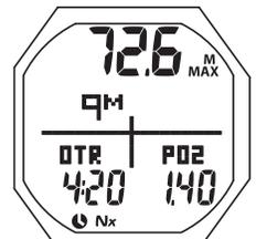
Fig. 32B - PDPS (control de oxígeno)
