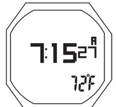
Fig. 117 - PANTALLA ALT. 2 MODO GAUG EN SUPERFICIE
