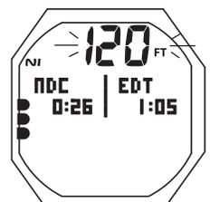
Fig. 140 - ALARMA DE PROFUNDIDAD DE DESCENSO
