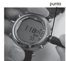
Fig. 159A - CABLE DE INTERFAZ PARA LA PC (inserte con el punto a las 12 en punto)
