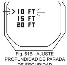
Fig. 51B - AJUSTE PROFUNDIDAD DE PARADA DE SEGURIDAD
