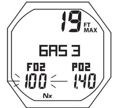
Fig. 38 - AJUSTE FO<sub>2</sub> PARA GAS 3
