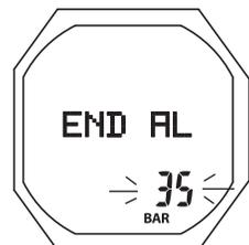
Fig. 46 - AJUSTE ALARMA PRESIÓN DE LLEGADA
