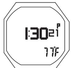
Fig. 107 - PANTALLA ALT. 2 ALARMA DE PO<sub>2</sub>
