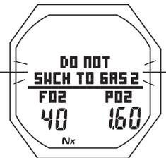
Fig. 111 - ALARMA DE CAMBIO DE GAS
