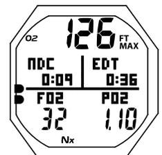
Fig. 81 - SOSTA IN PROFONDITÀ ALT 1
