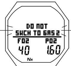
Fig. 111 - ALLARME COMMUTAZIONE GAS
