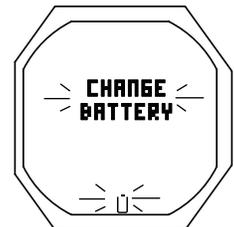
Fig. 3 - ALLARME BATTERIA OC1 SCARICA
