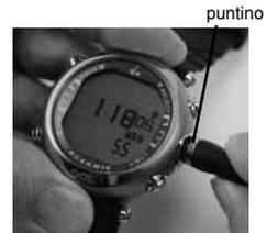
Fig. 159A - CAVO DI INTERFACCIA PC (inserirlo posizionando il puntino a ore 12)
