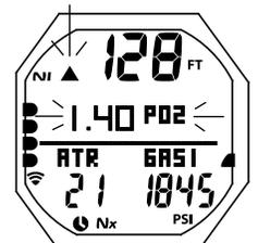
Fig. 101 - ALLARME PO<sub>2</sub> PRINCIPALE
