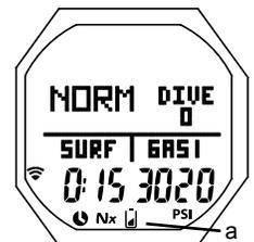
Fig. 2 - AVVERTENZA BATTERIA OC1 SCARICA
