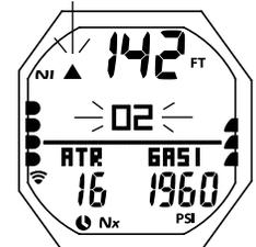
Fig. 104 - AVVISO O<sub>2</sub> ALTO (80%) (durante l'attivazione dell'allarme acustico)
