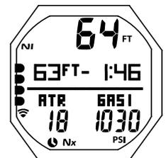
Fig. 80 - SOSTA IN PROFONDITÀ PRINCIPALE
