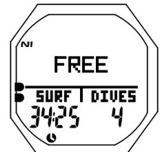
Fig. 124B - FREE SURF PRINCIPALE (34 min. dopo l'immersione n. 4)
