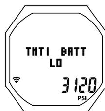
Fig. 6 - STATO BATTERIA TMT
