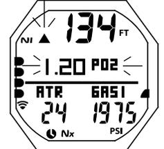
Fig. 100 - AVVERTENZA PO<sub>2</sub> (durante l'attivazione dell'allarme acustico)
