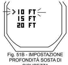
Fig. 51B - IMPOSTAZIONE PROFONDITÀ SOSTA DI SICUREZZA
