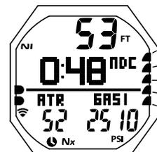
Fig. 70 - IMMERSIONE PRINCIPALE (velocità di risalita eccessiva)
