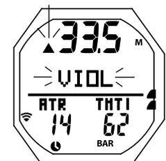
Fig. 96B - VIOLAZIONE MODALITÀ GAUGE PRINCIPALE (dopo l'allarme acustico)
