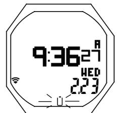
Abb. 5 - UHRMODUS (Alarm Batt. schwach)
