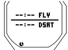
Abb. 30B - FLY/SAT (< 10 Min. nach Tauchgang)
