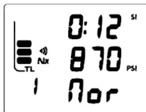
Fig. 15B - PRINCIPAL SUPERFICIE NORMAL (12 min después de la inmersión n.º 1)
