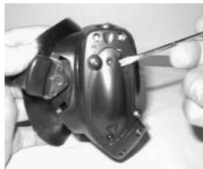
Fig. 115 - APERTURA CUBIERTA BATERÍA
