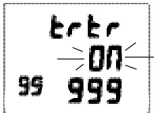
Fig. 37A - AJUSTE CÓDIGO CONEXIÓN (ON / OFF)
