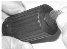
Fig. 118 - RIMOZIONE COPERTURA BATTERIA TRASMETTITORE
