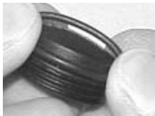
Fig. 119 - INSTALLAZIONE O-RING TRASMETTITORE
