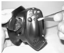
Fig. 115 - RIMOZIONE COPERCHIO BATTERIA
