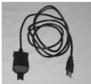
Fig. 113 - PC-SCHNITTSTELLENKABEL
