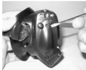
Fig. 115 - ENTFERNEN DES BATTERIEDECKELS
