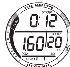
Fig. 41 - ALARMA DE PO 2 /DECO
