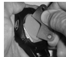
Fig. 50A - INSTALACIÓN DE LA CUBIERTA (con herramienta)
