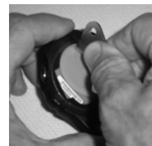
Fig. 46A - EXTRACCIÓN DE LA CUBIERTA (con herramienta)
