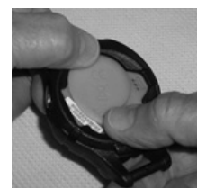
Fig. 46B - EXTRACCIÓN DE LA CUBIERTA (con los pulgares)
