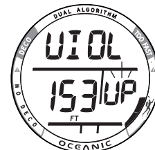
Fig. 37 - MODALITÀ VIOLAZIONE GAUGE PRINCIPALE
