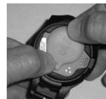
Fig. 50B - INSTALLAZIONE COPERCHIO (con i pollici)
