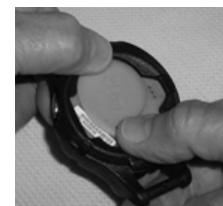
Fig. 46B - RIMOZIONE COPERCHIO (servendosi dei pollici)
