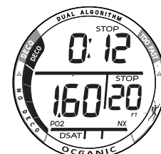
Fig. 41 - PO 2 ALLARME DECO
