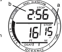
Fig. 5 - PROFONDEUR DE PALIER
