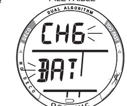
Fig. 8 - PILE FAIBLE (la situation s'est présentée au cours de la plongée)
