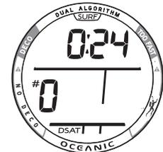
Fig. 10 - ÉCRAN PRINCIPAL SURFACE (aucune plongée effectuée jusque là)
