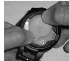
Fig. 50B - MISE EN PLACE DU COUVERCLE (avec les pouces)
