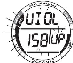
Fig. 36 - ACTIVATION DE L'INFRACTION AVEC LIMITATION AU MODE PROFONDIMÈTRE
