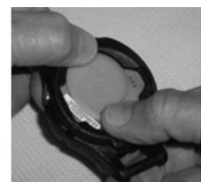
Abb. 46B - DECKEL ENTFERNEN (mit Daumen)
