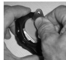
Abb. 46A - DECKEL ENTFERNEN (mit Werkzeug)
