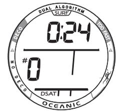
Fig. 10 - OBERFLÄCHE HAUPT (noch keinen Tauchgang durchgeführt)
