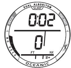
Abb. 11 - TAUCH HAUPT (während < 10 Minuten an der Oberfläche)
