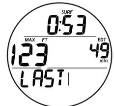
Fig. 125 - PANTALLA ALTERNATIVA 1 DEL MODO GAUG EN SUPERFICIE (datos de la última inmersión)
