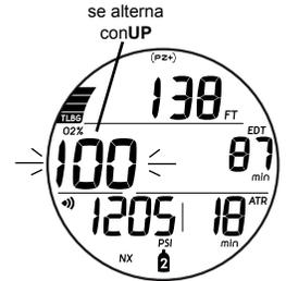
Fig. 115 - ALARMA DE O<sub>2</sub> PRINCIPAL (Sin parada)
