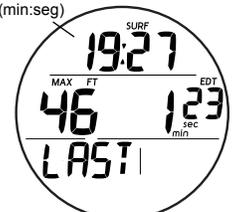
Fig. 134 - PANTALLA ALTERNATIVA 1 DEL MODO FREE EN SUPERFICIE (datos de la última inmersión)
