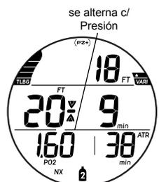
Fig. 113 - ALARMA PO<sub>2</sub> (durante la descompresión)
