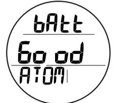
Fig. 79 - ESTADO DE LA BATERIA DEL ATOM
