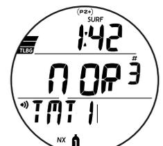
Fig. 6 - PRINCIPAL EN SUPERFICIE (alarma de batería baja del TMT)
