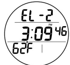
Fig. 126 - PANTALLA ALT. 2 MODO GAUG EN SUPERFICIE
