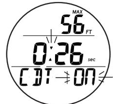
Fig. 146 - PANTALLA ALTERNATIVA INMERSIÓN MODO FREE (CDT encendido, funcionando)
