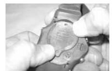
Fig. 160B - INSTALACIÓN DE LA CUBIERTA (con los pulgares)
