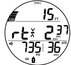
Fig. 99 - PRINCIPAL SS (configurado para el temporizador de recorrido)
