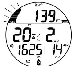
Fig. 100 - ENTRADA DESCOMPRESIÓN (durante la alarma sonora)
