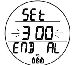
Fig. 56 - AJUSTE ALARMA PRESIÓN DE LLEGADA (se aplica sólo al TMT en uso)
