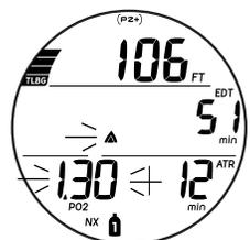
Fig. 112 - ALARMA PO<sub>2</sub> (durante la alarma sonora)
