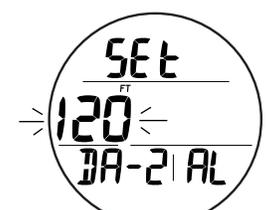
Fig. 142B - AJUSTE DA (valor de la profundidad)
