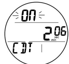
Fig. 137 - ESTADO DEL CDT (encendido, funcionando)
