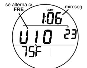
Fig. 152 - VIOLACIÓN EN MODO FREE (luego de 1 min en superficie)
