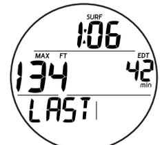
Fig. 34 - ALT 1 MODO NORM EN SUPERFICIE (Datos de la última inmersión)
