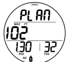
Fig. 39B - INTRO. PLANIFICACIÓN (FO<sub>2</sub> Gas 1 ajustado para Nitrox)
