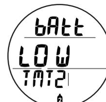
Fig. 5 - ESTADO DE LA BATERÍA DEL TMT (advertencia de batería baja)
