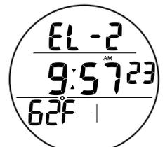
Fig. 35 - ALT 2 MODO NORM EN SUPERFICIE
