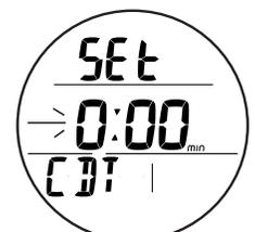
Fig. 14 - AJUSTE DEL CDT (luego de acceder desde el Estado)
