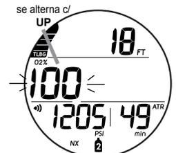
Fig. 116 - ALARMA DE O<sub>2</sub> PRINCIPAL (durante la descompresión)
