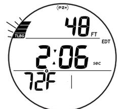
Fig. 150 - ALARMA DEL TLBG EN MODO FREE (durante la alarma sonora)
