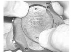
Fig. 156B - EXTRACCIÓN DE LA CUBIERTA (con los pulgares)
