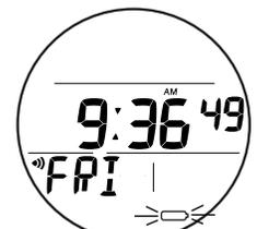
Fig. 3 - PRINCIPAL RELOJ (alarma de batería baja)
