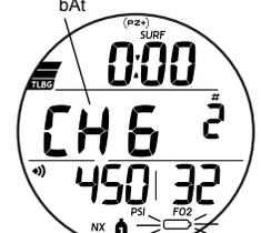
Fig. 4 - PRINCIPAL EN SUPERFICIE (alarma de batería baja durante la inmersión)
