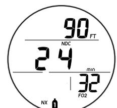
Fig. 40B - PDPS (FO<sub>2</sub> Gas 1 ajustado para Nitrox)
