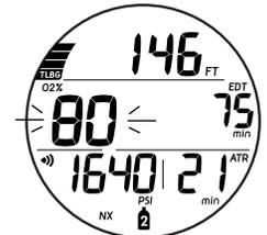
Fig. 114 - AVVERTENZA O<sub>2</sub> (durante l'attivazione dell'allarme acustico)
