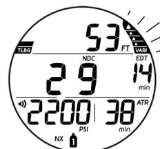
Fig. 86 - IMMERSIONE PRINCIPALE (velocità di risalita eccessiva)
