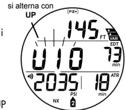
Fig. 109 - VIOLAZIONE MODALITÀ GAUGE PRINCIPALE (dopo l'allarme acustico)
