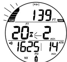
Fig. 100 - INGRESSO DECOMPRESSIONE (durante l'attivazione dell'allarme acustico)
