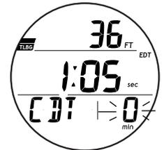
Fig. 147 - ALLARME CONTO ALLA ROVESCIA
