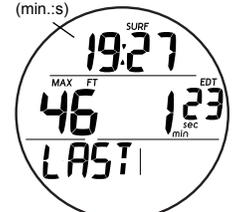
Fig. 134 - FREE SURF ALT 1 (dati relativi all'ultima immersione)
