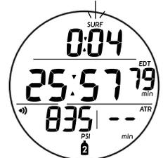
Fig. 130 - IMMERSIONE GAUG PRINCIPALE (per < 10 min. in superficie)
