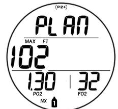
Fig. 39B - SCHERMATA INTRODUTTIVA PLAN (FO<sub>2</sub> Gas 1 impostata su Nitrox)
