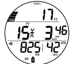
Fig. 98 - PRINCIPALE SOSTA DI SICUREZZA (On - profondità/tempo impostati)
