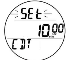
Fig. 139 - STATO CONTO ALLA ROVESCIA (impostato, pronto)
