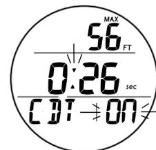
Fig. 146 - IMMERSIONE FREE ALT (conto alla rovescia On, in corso)
