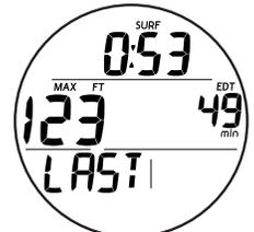
Fig. 125 - GAUG SURF ALT 1 (dati relativi all'ultima immersione)
