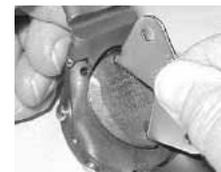
Fig. 156A - RIMOZIONE COPERCHIO (mediante attrezzo)
