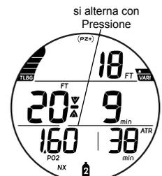
Fig. 113 - ALLARME PO<sub>2</sub> (in Decompressione)
