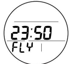
Fig. 37 - TEMPO DI ATTESA PRIMA DEL VOLO (a partire da 10 min. dopo l'immersione)
