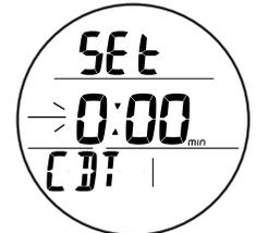
Fig. 14 - IMPOSTAZIONE CONTO ALLA ROVESCIA (dopo l'accesso da Stato)
