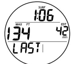
Fig. 34 - NORM SURF ALT 1 (dati relativi all'ultima immersione)
