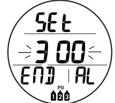
Fig. 56 - IMPOSTAZIONE ALLARME PRESSIONE FINALE (si applica al TMT in uso)
