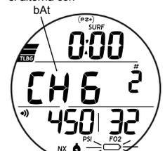
Fig. 4 - SURF PRINCIPALE (allarme batteria scarica durante l'immersione)
