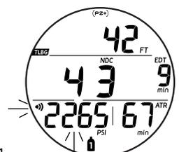
Fig. 82 - PERDITA DI COLLEGAMENTO
