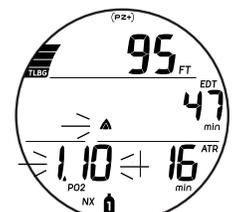
Fig. 111 - AVVISO PO<sub>2</sub> (durante l'attivazione dell'allarme acustico)
