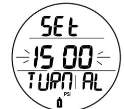
Fig. 55 - IMPOSTAZIONE ALLARME METÀ PRESSIONE (si applica esclusivamente al TMT 1)
