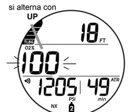
Fig. 116 - ALLARME O<sub>2</sub> PRINCIPALE (in modalità Decompressione)
