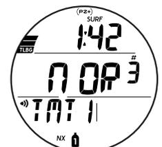
Fig. 6 - SURF PRINCIPALE (allarme batteria TMT scarica)
