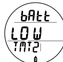
Fig. 5 - STATO BATTERIA TMT (avvertenza batteria scarica)
