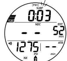
Abb. 93 - NULLZEIT HAUPT (während < 10 Minuten an der Oberfläche)
