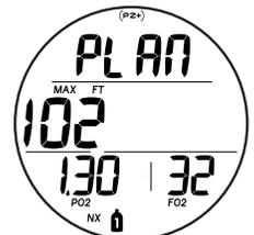
Abb. 39B - PLAN EINLEITUNG (FO<sub>2</sub> Gas 1 für Nitrox eingestellt)
