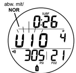
Abb. 110 - VGM HAUPT (an der Oberfläche < 10 Minuten)
