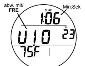
Abb. 152- FREE VERSTOSS (während 1 Minute an der Oberfläche)
