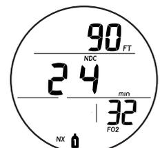
Abb. 40B - PDPS (FO<sub>2</sub> Gas 1 für Nitrox eingestellt)
