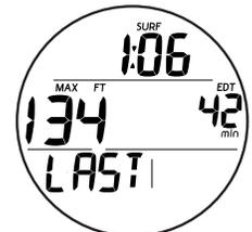
Abb. 34 - NORM SURF ALT 1 (Datum letzter Tauchgang)
