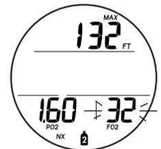
Abb. 47B - EINSTELLEN FO<sub>2</sub> GAS 2 (für Nitrox)
