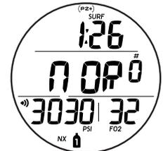
Abb. 32 - NORM SURF HAUPT (noch keinen Tauchgang durchgeführt)
