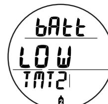
Abb. 5 - TMT BATTERIESTATUS (Warnung Batterie schwach)
