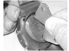
Abb. 156A - DECKEL ENTFERNEN (mit Werkzeug)
