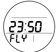
Abb. 37 - FLUGVERBOTSZEIT (startet 10 Min. nach Tauchgängen)
