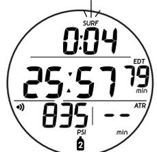
Abb. 130 - GAUG DIVE HAUPT (während < 10 Minuten an der Oberfläche)
