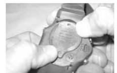
Abb. 160B - DECKEL EINLEGEN (mit Daumen)
