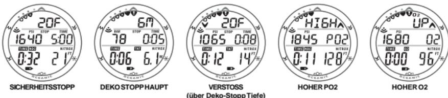
Bei Nullzeit Tauchgängen tiefer als 9 Meter (30 Fuß) wird ein Sicherheitsstopp angezeigt (je nach Einstellung). Die Tiefe/Zeit des Sicherheitsstopps ist abhängig von der Einstellung. Ein Aufstieg während des angezeigten Stopps wird nicht bestraft.
