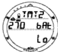
Fig.38 A TMT2 batteria LOW (scarica)
