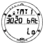
Fig.6.A -TMT1 batteria scarica
