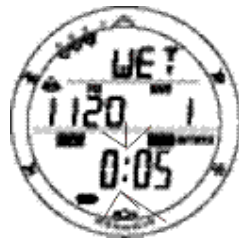
Fig.34-Modalità Superficie NORM (dopo immersione unità in acqua)
