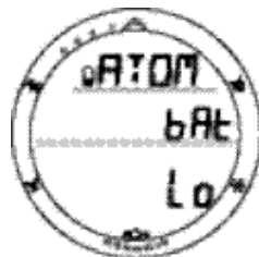
Fig.36- Batterie Atom basse
