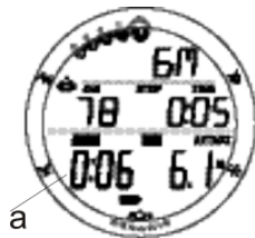
Fig. 94 – schermo di stop di decompressione principale
