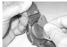
Fig. 118A - Smontaggio del coperchio dell'ATOM
