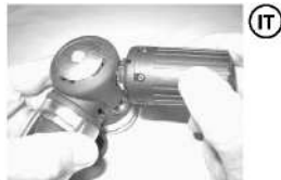
Fig. 127 -Avvitamento del trasmettitore sull'erogatore
