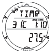
Fig. 138 - Affichage principal plongée FREE (pendant alarme)
