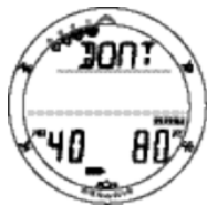
Fig. 106 - Alarme "Ne pas changer de gaz".
