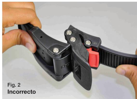
Para extraer la banda de sujeción de la botella, levante el asa de la leva. Presione el seguro del trinquete para aflojar la banda. Puede aflojarlo lo suficiente como para elevarlo de la botella o extraer la banda completamente fuera de la hebilla.
