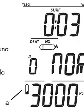
Fig. 1 - BATTERIA SCARICA
