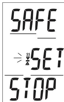
Fig. 31A - RÉGLAGE D'UN PALIER DE SÉCURITÉ
