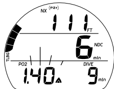
Fig. 73 - PRINCIPAL ALARMA DE PO2
