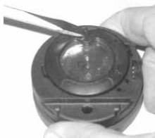
Fig. 109 - ANILLO DE LA CUBIERTA
