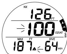
Fig. 76 - ALARMA DE O2
