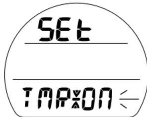
Fig. 30B - IMPOSTAZIONE CRONOMETRO SOSTA DI SICUREZZA
