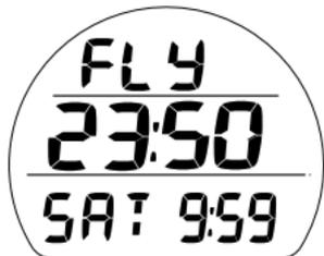
Fig. 7B - FLY/SAT (10 min. dopo l'immersione)
