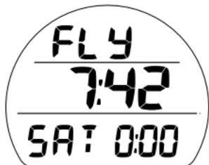
Fig. 7C - FLY/SAT (nessun tempo di desaturazione residuo)
