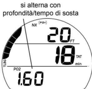
Fig. 74 - ALLARME PO2 (in Decompressione)
