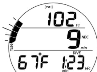
Fig. 103 - ALLARME TLBG FREE (durante l'attivazione dell'allarme acustico)
