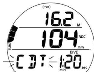
Fig. 100 - ALLARME CONTO ALLA ROVESCIA
