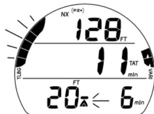
Fig. 61 - INGRESSO DECOMPRESSIONE (durante l'attivazione dell'allarme acustico)
