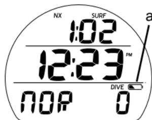
Fig. 1 - BATTERIA SCARICA
