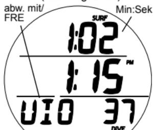
Abb. 128- FREE VERSTOSS (während 1 Minute an der Oberfläche)
