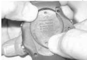
Fig. 132B - EXTRACCIÓN DE LA BATERÍA (con los pulgares)
