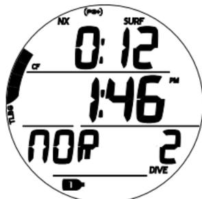
Fig. 29 - PRINCIPAL SUPERFICIE MODO NORM (> 10 min después de la inmersión nº 2)
