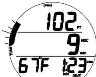
Fig. 126 - ALARMA DEL TLBG EN MODO FREE (durante la alarma sonora)
