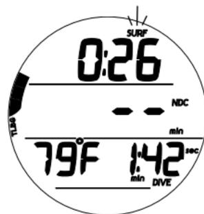
Fig. 120 - PRINCIPAL INMERSIÓN EN MODO FREE (durante < 1 min en superficie)
