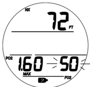
Fig. 43 - AJUSTE FO2 PARA GAS 2
