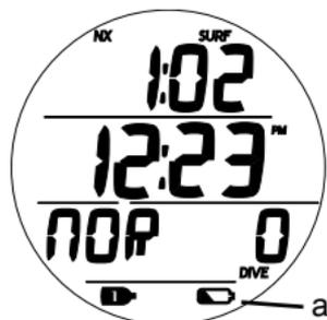
Fig. 1 - PRINCIPAL EN SUPERFICIE (advertencia de batería baja)
