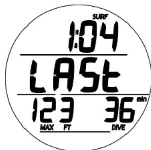
Fig. 30 - ALT 1 MODO NORM EN SUPERFICIE (Datos de la última inmersión)
