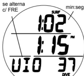
Fig. 128 - VIOLACIÓN EN MODO FREE (luego de 1 min en superficie)
