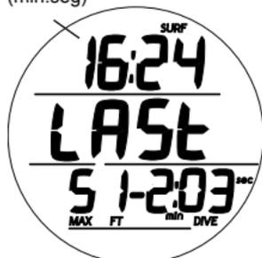
Fig. 109 - PANTALLA ALTERNATIVA 1 DEL MODO FREE EN SUPERFICIE (datos de la última inmersión)
