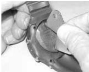
Fig. 132A - EXTRACCIÓN DE LA BATERÍA (con herramienta)
