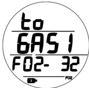
Fig. 98 - VISTA PREVIA DEL CAMBIO DE GAS 1
