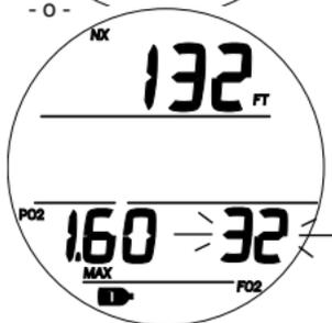
Fig. 42 - AJUSTE FO2 PARA GAS 1
