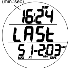
Fig. 109 - FREE SURF ALT 1 (dati relativi all'ultima immersione)
