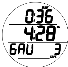
Fig. 100 - GAUG SURF PRINCIPALE (nessuna immersione ancora effettuata)
