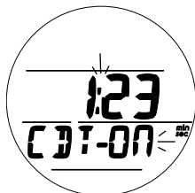
Fig. 112 - STATO CONTO ALLA ROVESCIA (On, in corso)
