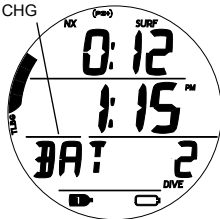
Fig. 3 - SURF PRINCIPALE (allarme batteria scarica durante l'immersione)
