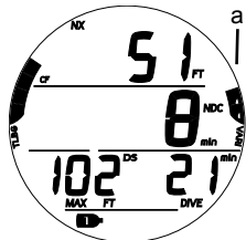
Fig. 68 - IMMERSIONE PRINCIPALE (velocità di risalita normale)
