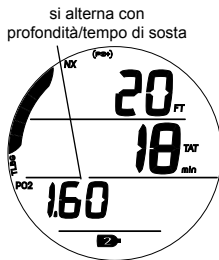
Fig. 94 - ALLARME PO2 (in Decompressione)
