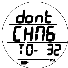
Fig. 99 - ALLARME COMMUTAZIONE GAS (tutti i valori lampeggianti)
