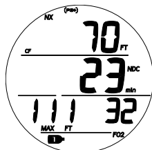
Fig. 35A - PDPS (controllo azoto)
