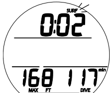
Fig. 104 - IMMERSIONE GAUG PRINCIPALE (periodo < 10 min. in superficie)
