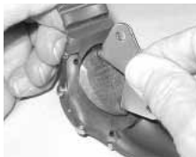
Fig. 132A - RIMOZIONE DEL COPERCHIO (mediante attrezzo)
