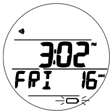
Fig. 2 - MODALITÀ OROLOGIO (allarme batteria scarica)
