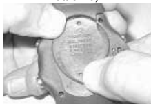
Fig. 132B - RIMOZIONE DEL COPERCHIO (servendosi dei pollici)
