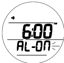
Fig. 16 - STATO SVEGLIA GIORNALIERA (in fase di accesso)
