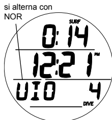
Fig. 91 - VIOLAZIONE MODALITÀ GAUGE SURF PRINCIPALE
