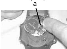
Fig. 133 - RIMOZIONE DELLA BATTERIA
