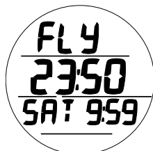
Fig. 33B - FLY/SAT (10 min. dopo l'immersione)
