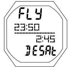
Fig. 22 - PROHIBICIÓN DE VUELO/DESATURACIÓN (10 min después de la inmersión)
