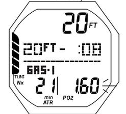
Fig. 93 - ALARMA PO2 (Deco, durante la alarma sonora)
