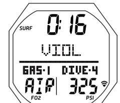
Fig. 90B - PRINCIPAL MODO VGM EN SUPERFICIE (luego de que pasen 10 minutos)
