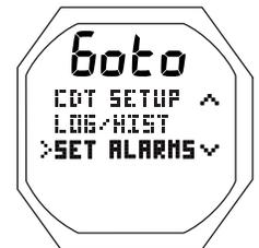
Fig. 131 - MENÚ PRINCIPAL (para acceder al ajuste de alarmas)
