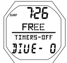
Fig. 114A - PRINCIPAL MODO FREE (APNEA) EN SUPERFICIE (sin ninguna inmersión, temporizadores apagados)
