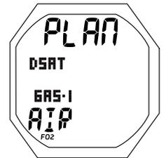
Fig. 23A - INTRO. PLANIFICACIÓN (Gas 1 ajustado para aire)
