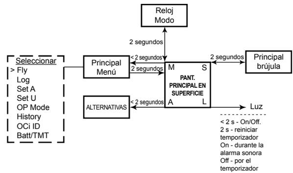
**ESTRUCTURA DEL MENÚ DE AJUSTE NORMAL Y PROFUNDÍMETRO**
