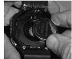
Fig. 182 - INSTALACIÓN DE LA BATERÍA
