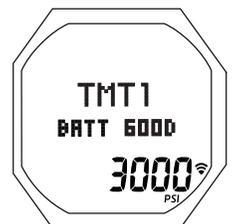
Fig. 60 - ESTADO DE LA BATERÍA DEL TMT
