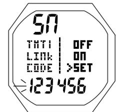
Fig. 52 - AJUSTE TMT SN (código de conexión)
