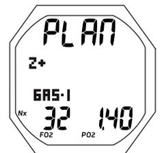
Fig. 23B - INTRO. PLANIFICACIÓN (Gas 1 ajustado para Nitrox)
