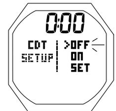
Fig. 6A - AJUSTE CDT (desactivado, aún no ajustado)
