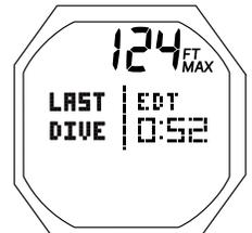
Fig. 18 - ALT 1 MODO NORM EN SUPERFICIE (Datos de la última inmersión)
