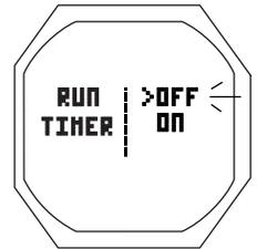
Fig. 107 - AJUSTE DEL TEMPORIZADOR DE RECORRIDO
