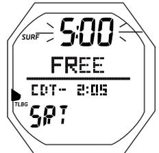
Fig. 150 - ALARMA DE SRT EN SUP.
