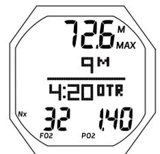
Fig. 24B - PDPS (control de oxígeno)
