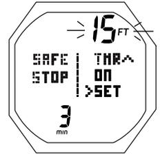
Fig. 46B - AJUSTE PARADA DE SEGURIDAD (ajustar tiempo y luego profundidad)
