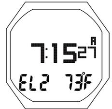
Fig. 104 - PANTALLA ALT. 2 MODO GAUG EN SUPERFICIE
