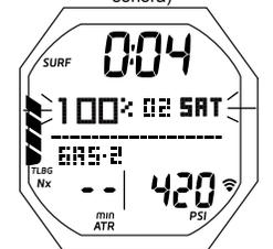
Fig. 97 - ALARMA DE O2 (en superficie)
