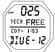
Fig. 114C - TECH FREE PANT. PRINCIPAL EN SUPERFICIE (luego de la inmersión, CDT en funcionamiento)
