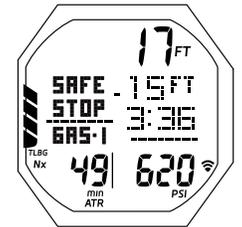
Fig. 78A - PRINCIPAL PARADA DE SEGURIDAD (profundidad/Tiempo fijado)
