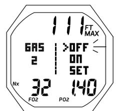
Fig. 31 - AJUSTE GAS 2 (Gas 3, 4 similar)
