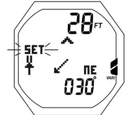
Fig. 165 - AJUSTE RUMBO DE REFERENCIA
