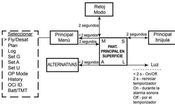
**ESTRUCTURA DEL MODO GAUG SURFACE (PROFUNDÍMETRO SUPERFICIE)**
