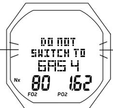
Fig. 101 - ALARMA DE CAMBIO DE GAS
