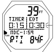
Fig. 152 - ALARMA DEL RTI EN LA INMERSIÓN
