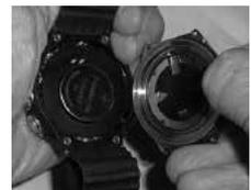
Fig. 179B - LEVANTAR TAPA DE LA BATERÍA
