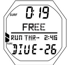
Fig. 114B - PRINCIPAL MODO FREE (APNEA) EN SUPERFICIE (después de la inmersión, temporizadores de recorrido en funcionamiento)
