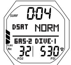
Fig. 17B - PRINCIPAL MODO NORM EN SUPERFICIE (4 minutos luego de la inmersión 1)
